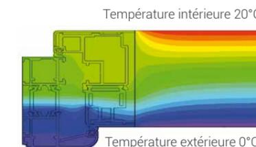
**Thermique :** calcul réalisé selon la norme EN ISO 10077-1 et -2 sur porte pleine avec dimension d'ouvrant de 2350 x 1070 mm et rejet d'eau. **AEV :** essais réalisés selon la norme NF P 20-501. N°404/2019/243-1 du 06/12/2019. **Ensoleillement :** selon norme NF EN 12219. **Acoustique :** Classification selon la norme ISO 717-1 sur porte pleine de dimension HT 2180 x 960 mm.
