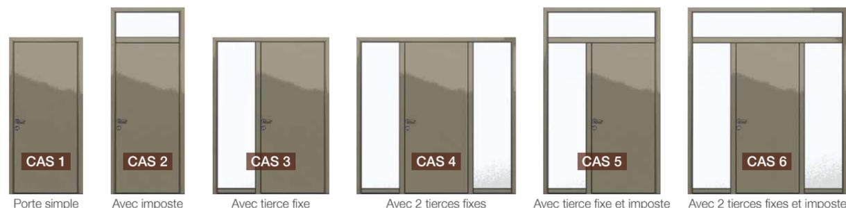
Possibilité d'inclure une ou deux traverses sur les tierces vitrées. Pas de traverse sur imposte. Dimensions MINI : selon le modèle choisi. Consulter le cahier technique.
